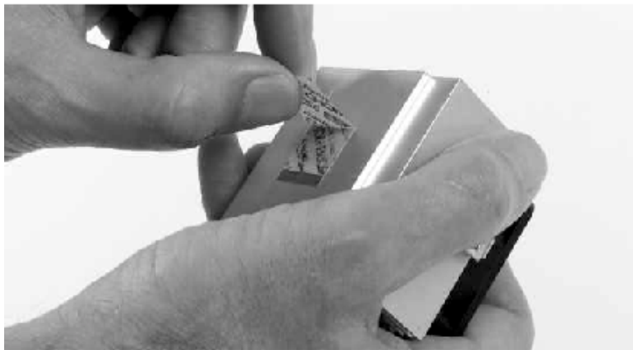
Abbildung 9: Folie mit rascher Bewegung von der Wärmeleitpaste abziehen
